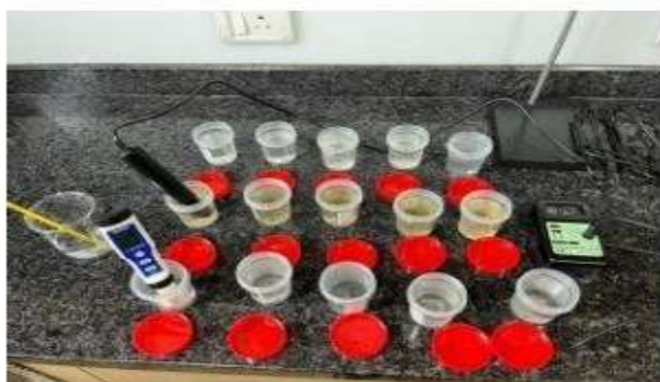
Fig.6.7:DataCollectionusingaDigitalMultiparameter and a Nephelometer
